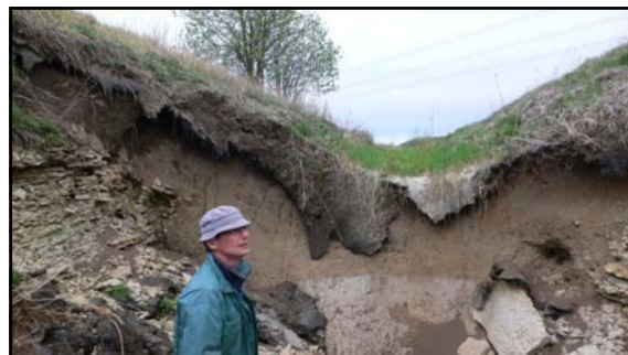
Затвердевший слой нефтепродуктов занесен землей и на нем появилась растительность. Река Эпра 2008
