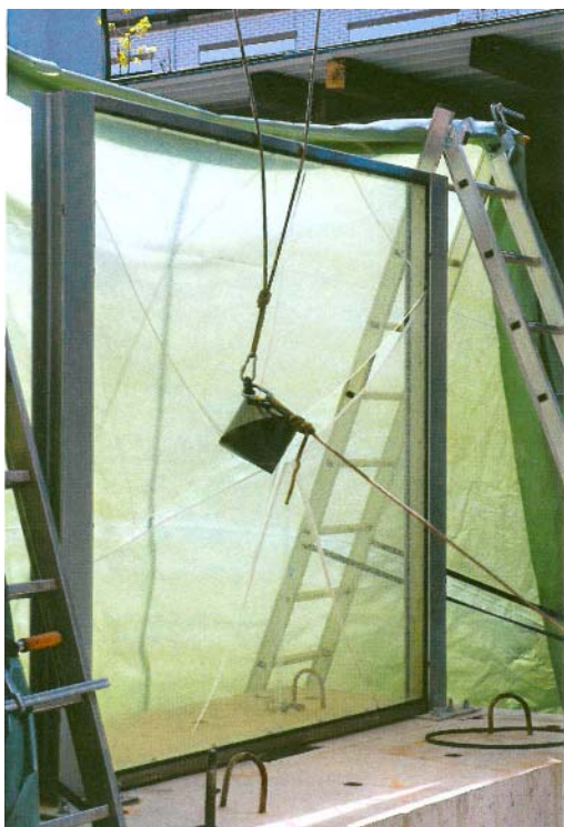
Pilt nr 8 (17789d-16): Element tähistusega L0706273/1 pendli löögi ajal
