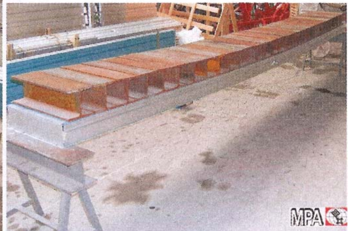
Joonis 3: esimene katseeksemplar 1,75-kordse tuulekoormuse all
