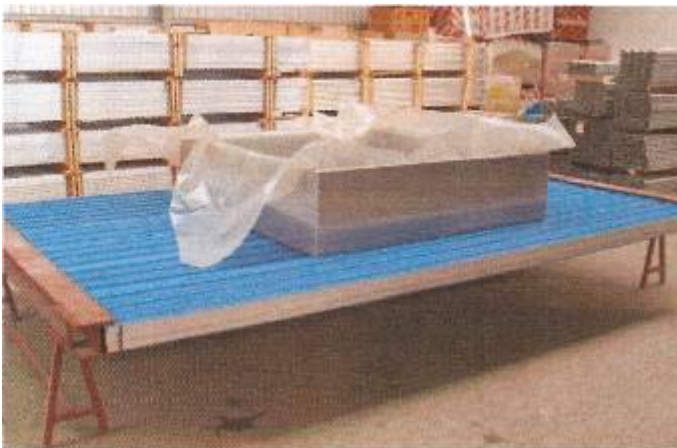
Foto 1: müratõkkeelement enne koormuskatset koos paigaldatud raamiga
