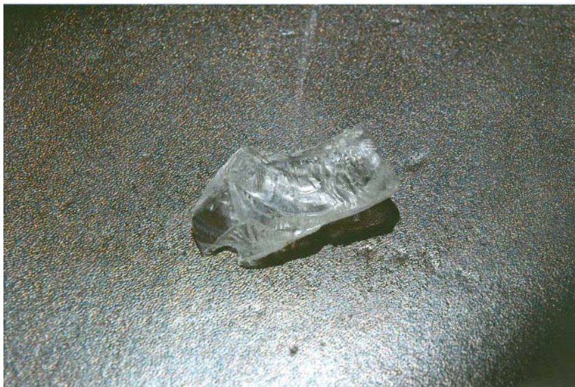
Foto nr 7 (17789d-23): akrüülklaasist väljakukkunud osa
