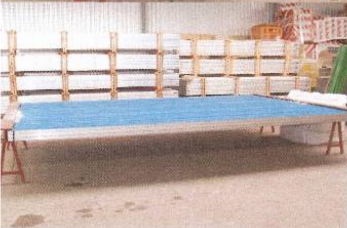
Foto 5: müratõkkeelement pärast koormuse eemaldamist
